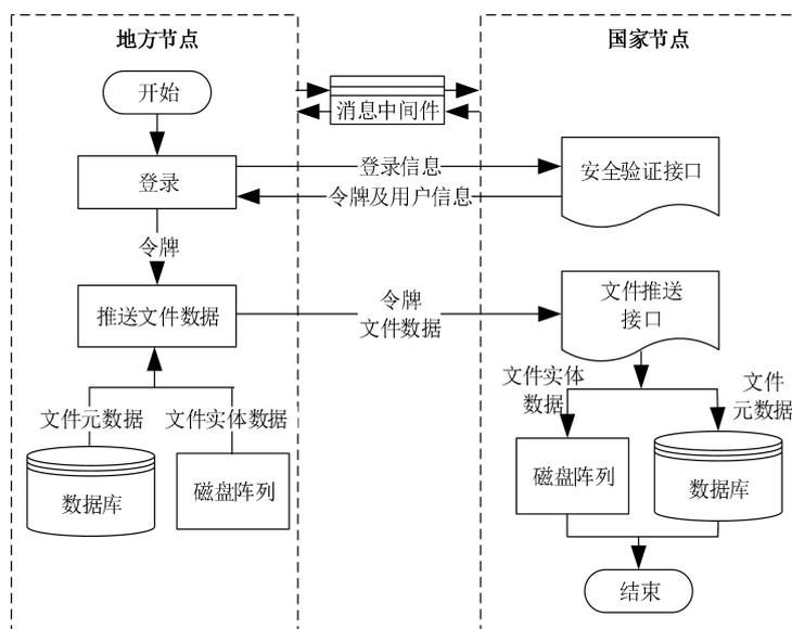
图5 文件推送接口调用流程图
