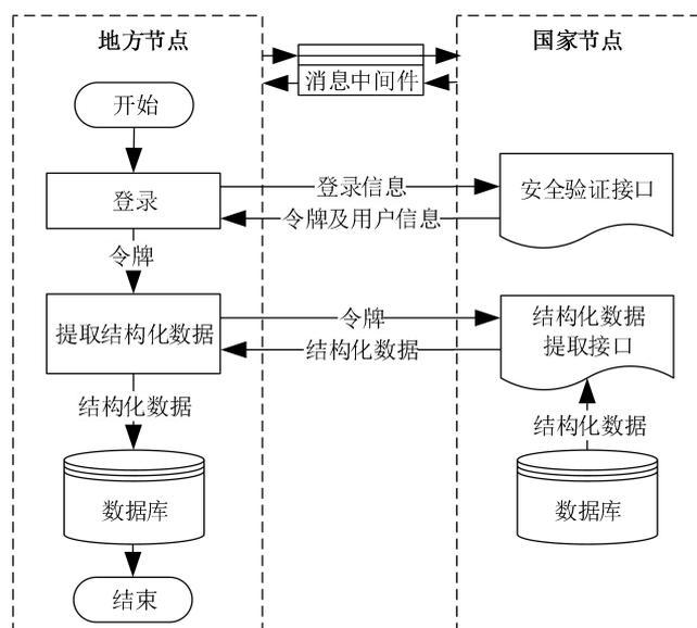
图4 结构化数据提取接口调用流程图
