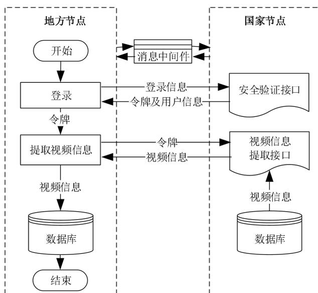
图 10 视频信息提取接口调用流程图
