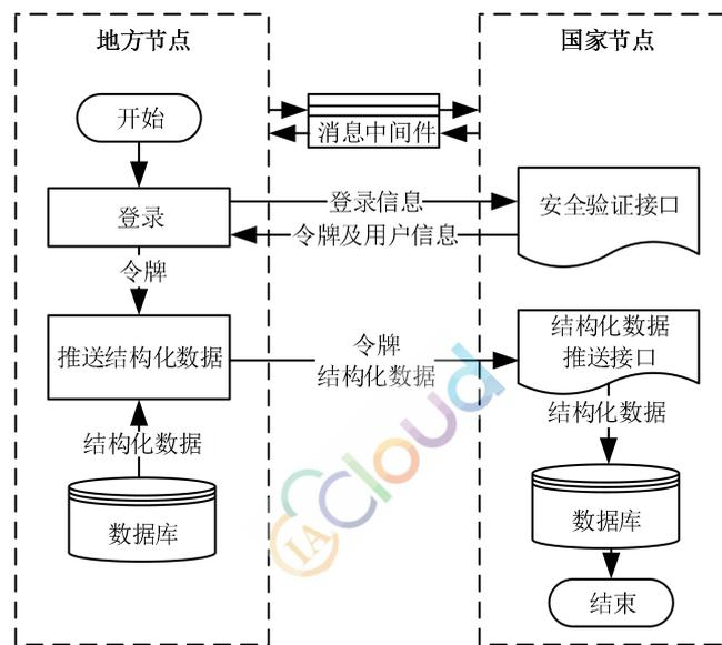
图 3 结构化数据推送接口调用流程图
