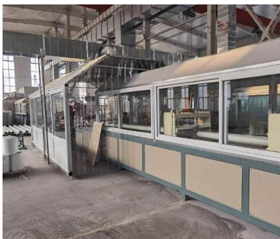
5 号车间拉挤工序密闭，连接集气罩
