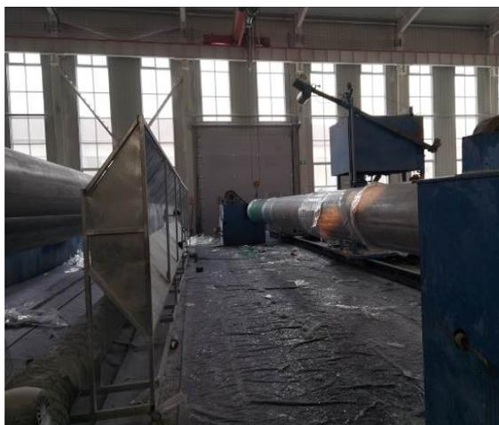
2 号车间缠绕工序侧方设置集气罩
