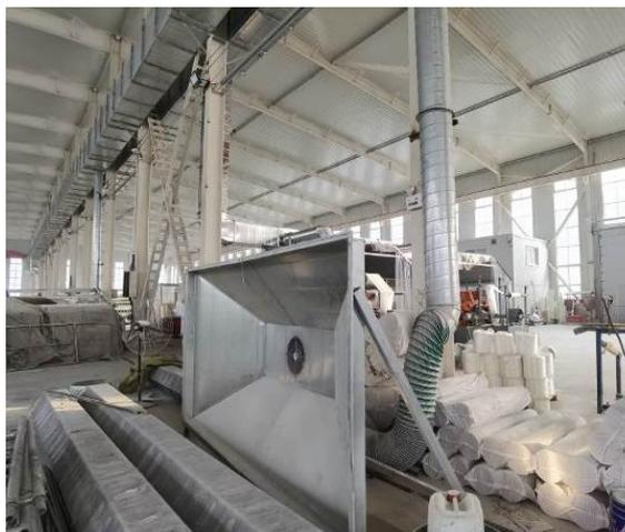
5 号车间缠绕工序侧方设置集气罩
